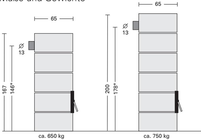
\*Abstand zwischen Oberkante fertiger Fußboden und Mitte Rauchrohr
