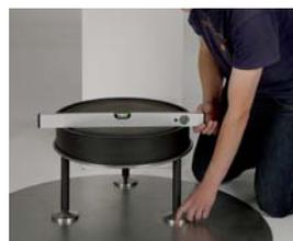
Bodenteil durch Drehen der Verstellfüße waagrecht ausrichten
