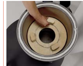
Stützen mit wenig Mörtel auf die markierten Stellen setzen
