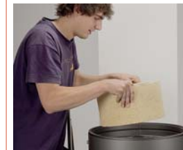
Zugring auf die Stützen setzen (mittig im Mantelring), anschließend Oberseite anfeuchten
