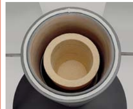
Zugring sofort auf die Zwischenplatte setzen
