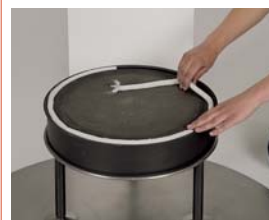
Dichtschnur beim Einlegen zusammenschieben (nicht dehnen!)
