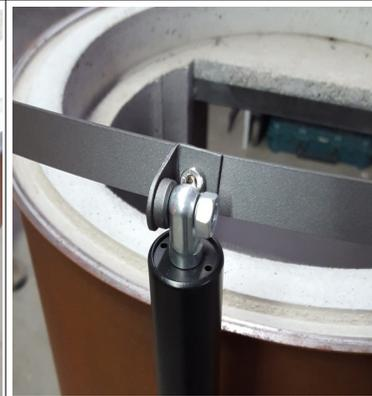
Zylinder an oberer Befestigung einhängen und mit Mutter sichern
