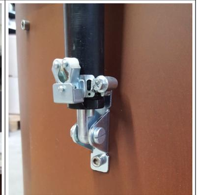
Zylinder mit der Schraube an der unteren Befestigung fixieren und die Arretierung ausrichten.
